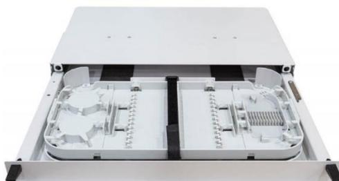
Patch panel de tipo deslizante para fibra óptica apropiado para la fusión de troncal de entrada con los cables de distribución. Puertos: 24 SC SX | Fusiones: 24 | Bandejas/Fusión: 2x12 | Adaptadores: 24 SC SX sin soporte
