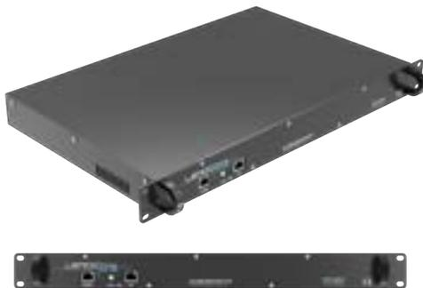
La serie **Pro Line** es una solución todo en uno que es altamente avanzada y versátil, diseñada para satisfacer las cambiantes necesidades de la industria de la radiodifusión. Con la capacidad de recibir hasta 16 señales independientes de satélite (DVB-S/S2), terrestres (DVB-T/T2) o por cable (DVB-C), el dispositivo puede convertirlas en streaming IPTV de 1 Gbit para distribuir programas de televisión y radio de FTA.
