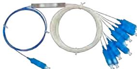
Splitter con Conector **SC/UPC** fibra G657A1 | Longitud 1 metro, diámetro  $\varnothing$  900  $\mu$ m | Temperatura -40 ~ +85  $^{\circ}$ C.
